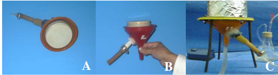
Figura 4-4.- Difusor de aire utilizado en las columnas nitrificantes
