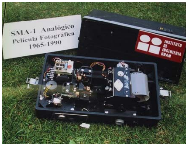
Figura 2.2 Equipo analógico SMA-1 con registro en película fotográfica.
