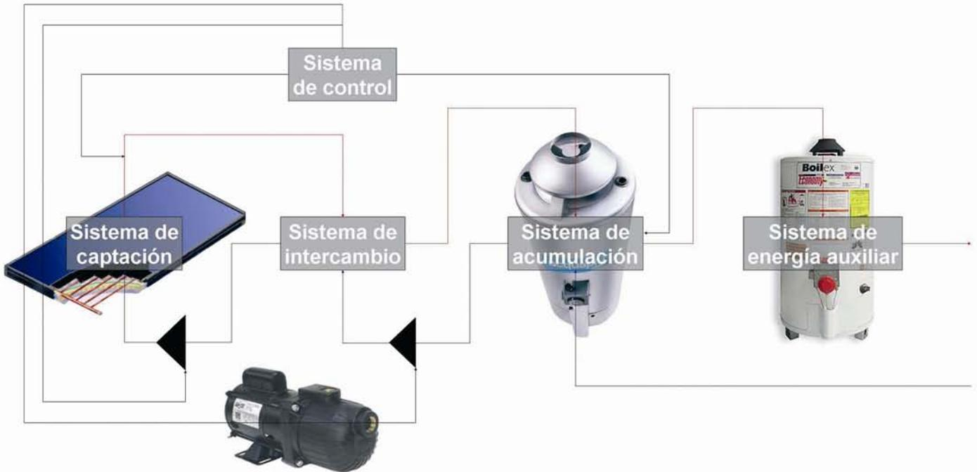
Esquema de un sistema de energía solar térmica
