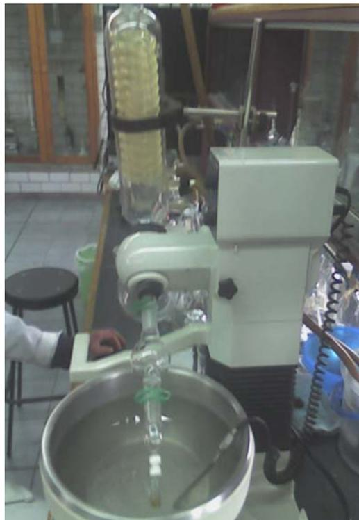
Figura 6: Destilación al vacío del hexano del extracto hexánico
