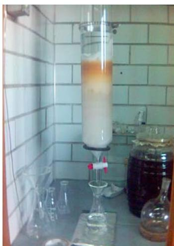
Figura 7: Cromatografía en columna correspondiente al fraccionamiento primario del extracto hexánico.
