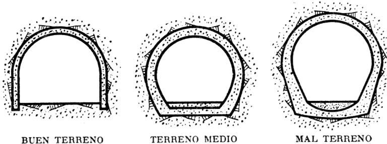
Fig. I.7 Secciones transversales de túneles para vías férreas<sup>(1)</sup>
