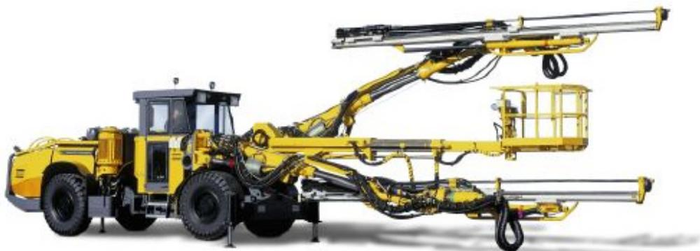
Fig. II-55 Rocket Boomer L2<sup>(15)</sup>
