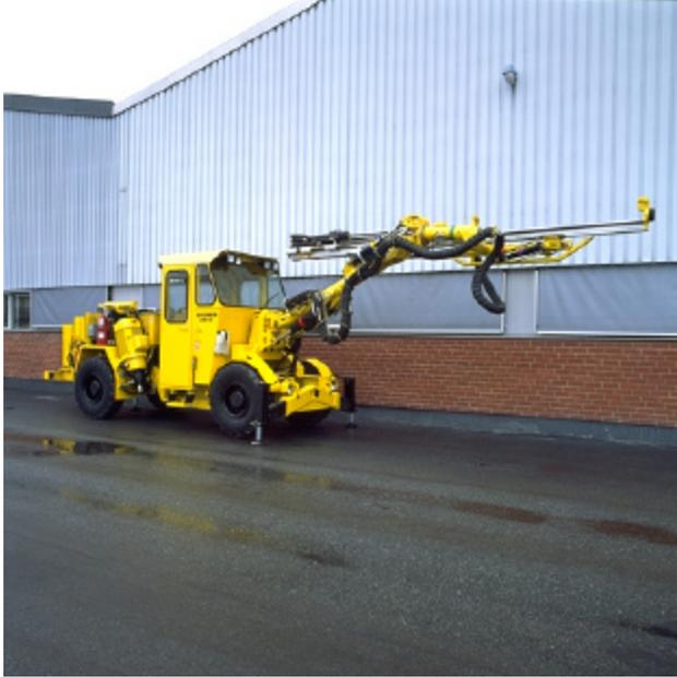
Fig. II-50 Rocket Boomer H 281-38 COP 1238<sup>(15)</sup>
