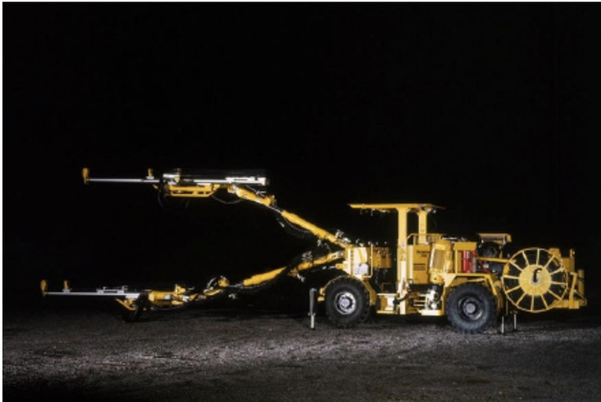
Fig. II-51 Rocket Boomer H 282-38 COP 1238<sup>(15)</sup>
