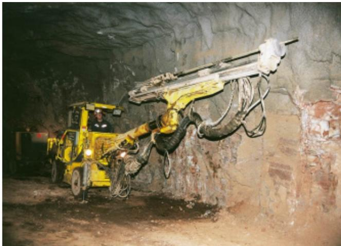
Fig. II-49 Rocket Boomer H 104-38 COP 1238<sup>(15)</sup>
