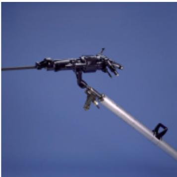
FIG II-47 Perforadora (puma BBC 94W)<sup>(15)</sup>
