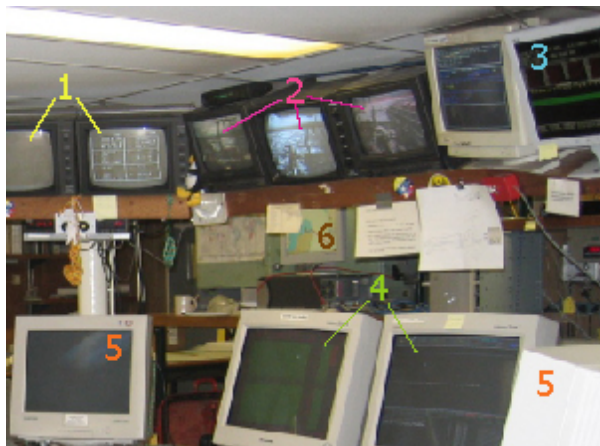
Figura 39. Pantallas de monitoreo del equipo y procedimientos a bordo de la embarcación. Los números en la Figura identifican los parámetros monitoreados en cada una de ellas, 1) Posición de la embarcación en coordenadas geográficas, velocidad del crucero, velocidad respecto al fondo marino, rumbo, etc. 2) Imágenes de diferentes áreas de la embarcación. 3) Control de la flotabilidad del tendido de hidrófonos. 4) Inspección del estado de las pistolas neumáticas, en la pantalla del lado izquierdo se puede observar el impulso generado por los disparos (en la pantalla ubicada a la derecha se verifica la sincronía de las pistolas neumáticas en cada disparo). 5) Trayectoria y transectos del trabajo de prospección. 6) Pantalla de posicionamiento GPS.
