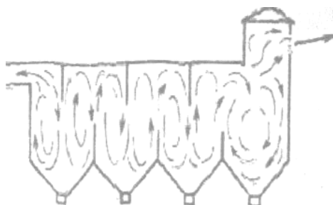
fig. 22 Configuración del flujo en una Cámara de Sedimentación
