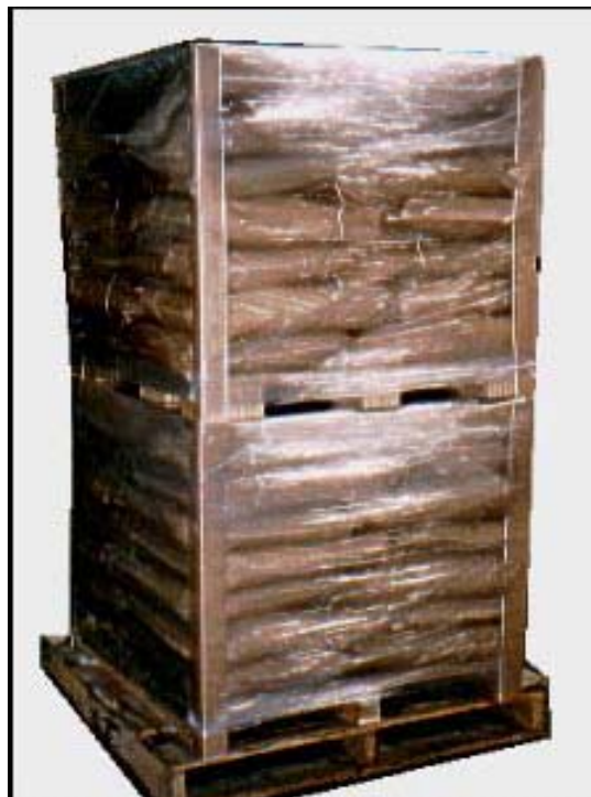
SE HAN COLOCADO ESQUINEROS Y PELÍCULA PLÁSTICA PARA MEJORAR LA ESTIBA
