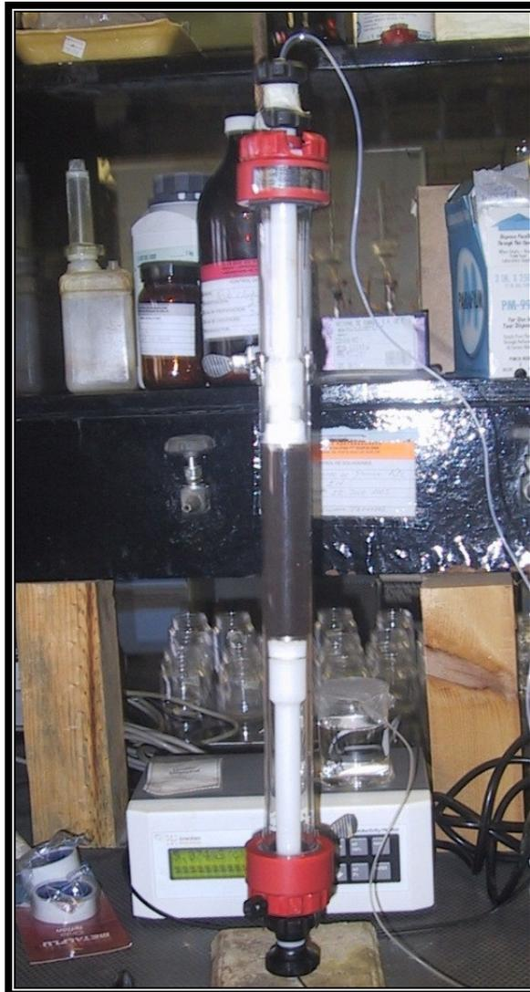
**Figura 5.7. Columna automatizada**
