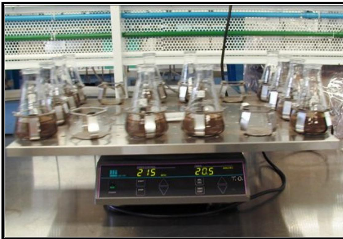
Figura 4.9. Muestras de suelo en agitador
