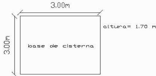
LA CISTERNA SERA DE CONCRETO ARMADO, CAPACIDAD DE 15,000 Lts. ó 15 m<sup>3</sup> ES DECIR, 3.0m X 3.0m DE BASE X 1.7m DE ALTURA
