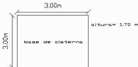
LA CISTERNA SERÁ DE CONCRETO ARMADO, CAPACIDAD DE 15,000 Lts. ó 15 m<sup>3</sup>; ES DECIR, 3.0m X 3.0m DE BASE X 1.7m DE ALTURA
