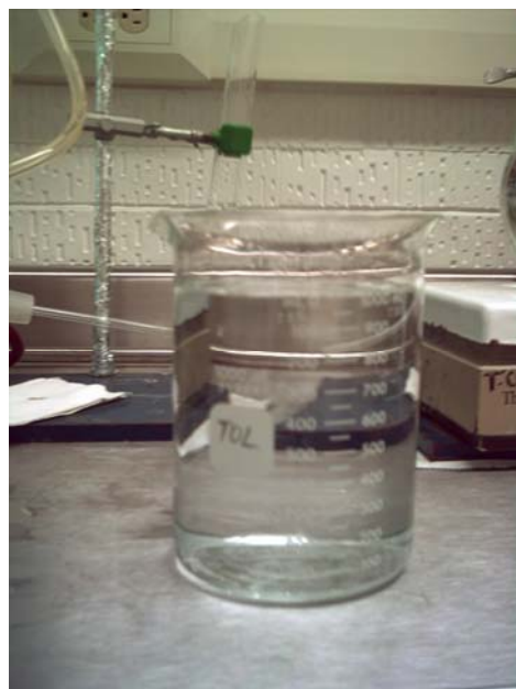
Titulación de la muestra con Tiosulfato de Sodio 0.1N, en la determinación de ozono gas a la salida.
