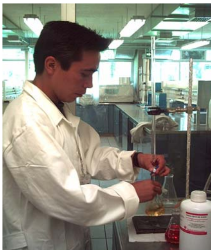
Titulación de la muestra con Tiosulfato de Sodio 0.1N, en la determinación de ozono gas a la salida.
