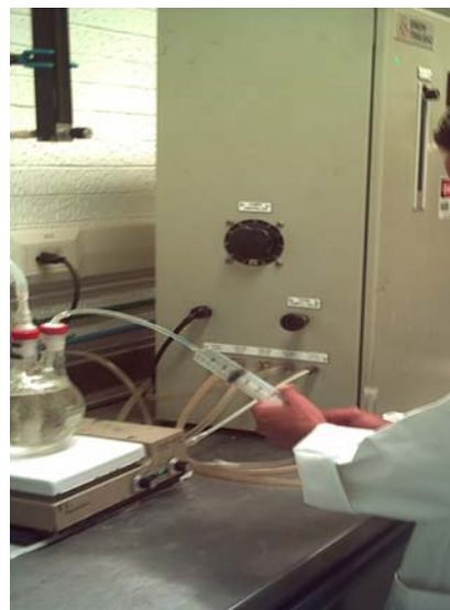
2.-Toma de muestra para evaluar la concentración del ozono residual en el líquido.
