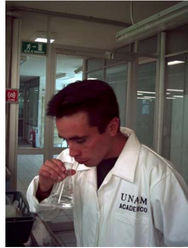
2.- Determinación del número umbral de olor, a una temperatura de 40°C y a pH de 7.5.
