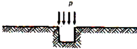
Configuración de asentamientos supuesta al modelar el suelo con resortes independientes
