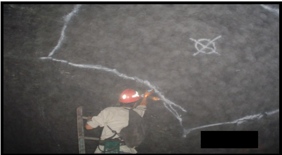
Fig No 10. CONTROL GEOLÓGICO EN REBAJE DE EXPLOTACIÓN. OBSERVESE COMO LA CUADRILLA DE TOPOGRAFÍA MARCA LINEAS CADA 4 m PARA LA ORIENTACIÓN DEL DETALLE GEOLÓGICO.
