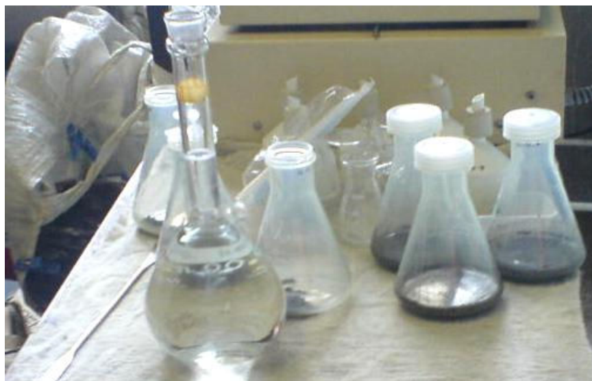
Fig. No. 1 Preparación de la solución y de la muestra de escoria a lixiviar
