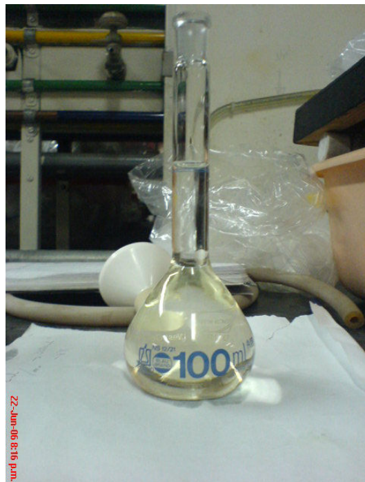
Fig. No. 3 Aforo del filtrado para su análisis en el EAA
