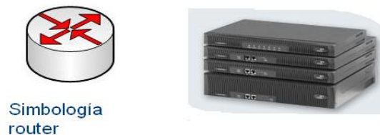
Figura 1.5. Simbología lógica de un router y modelo estándar
