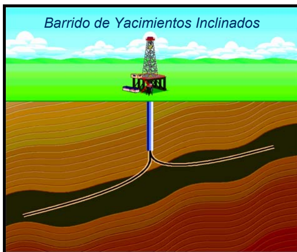
FIGURA II.6.b PRINCIPALES APLICACIONES DE POZOS MULTILATERALES.
