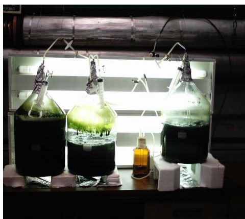
Figura 2.4 Bioreactores con cultivo de microorganismos en planta piloto (cultivos de Spirulina maxima 2342)
