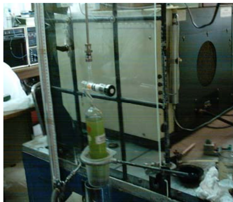
Figura 2.7 Bioreactor acoplado al Cromatógrafo de gases con TCD
