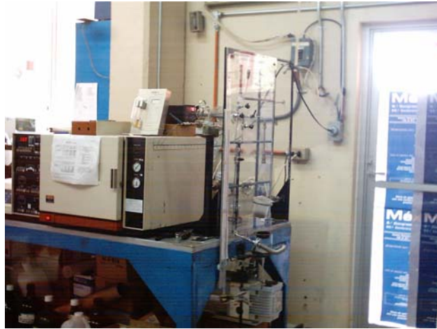
Figura 2.6 Cromatógrafo de gases con TCD
