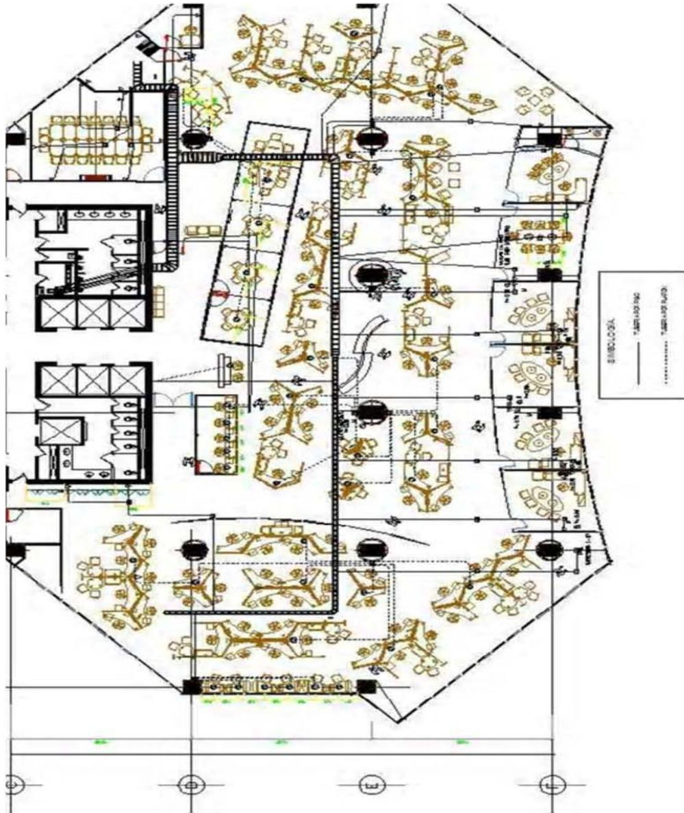
Croquis que muestra la trayectoria de las tuberías por piso, plafón y los registros del piso 3.
