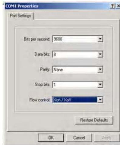
Fig. 4.29 Configuración del Puerto COM 1.
