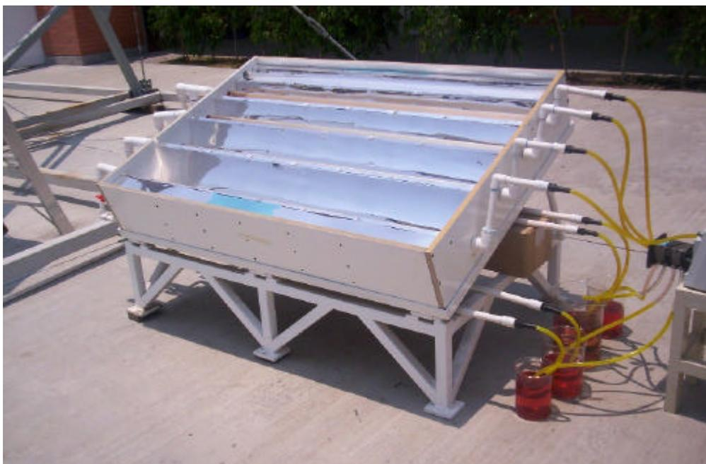
Figura 4.5. Fotografía del CPCM fabricado en el CIE-UNAM.
