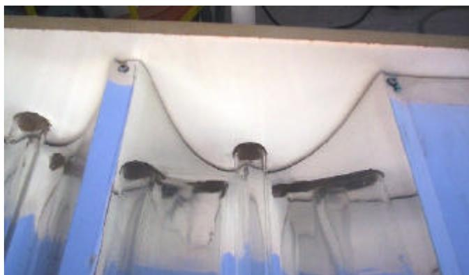
Figura 4.2. Fotografía de un CPC de 1.5 soles de concentración.
