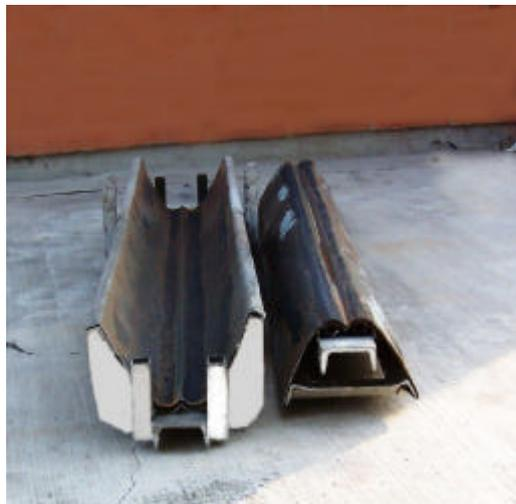
Figura 4.3. El primer troquel diseñado en el Taller Mecánico del CIE para fabricación de CPC.
