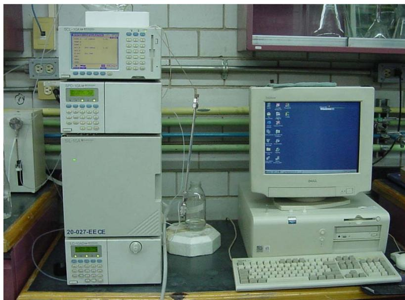
Figura 5. Cromatógrafo de líquidos de alta resolución.
