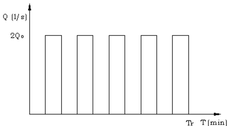
[Figura 3.3: Hidrograma para el RI en un surco de la segunda batería]
