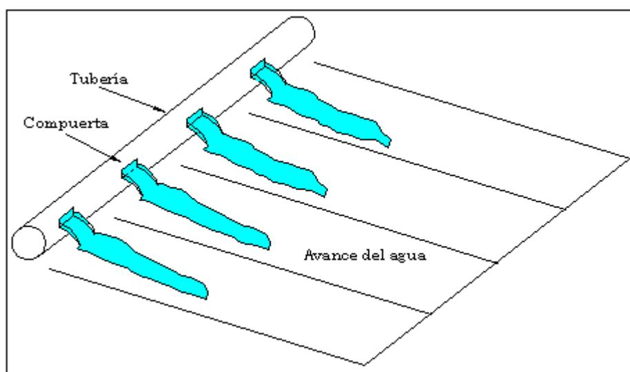
[Figura 3.5: Tubería multicompuerta utilizado en el RIG]
