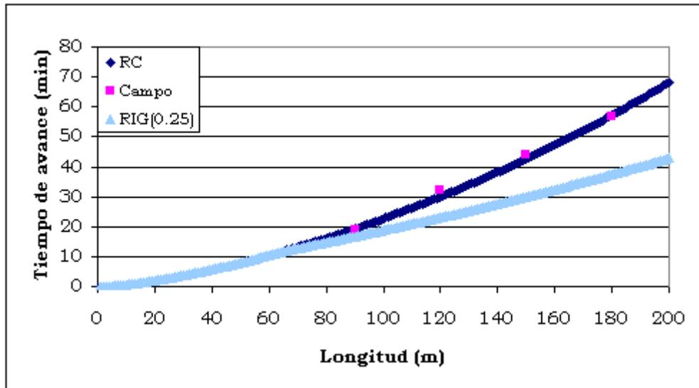
[Figura 5.2: Curva de avance en el RIG]
