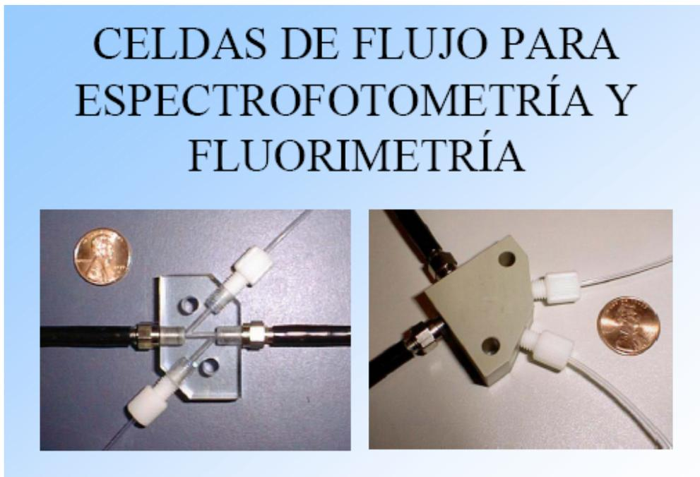
**Figura 7.** Celda de Peek. (Zona de detección).
