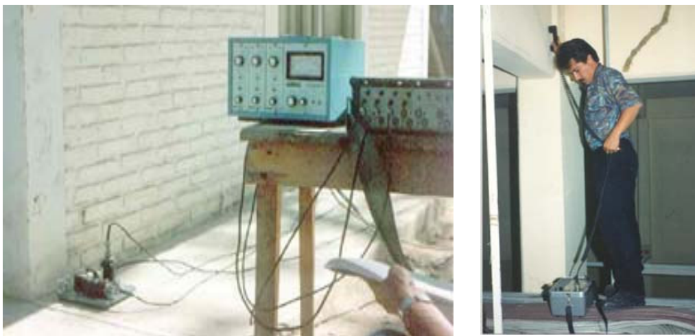
Figura III.XVII Imagen de la toma de detección del acero en el edificio
