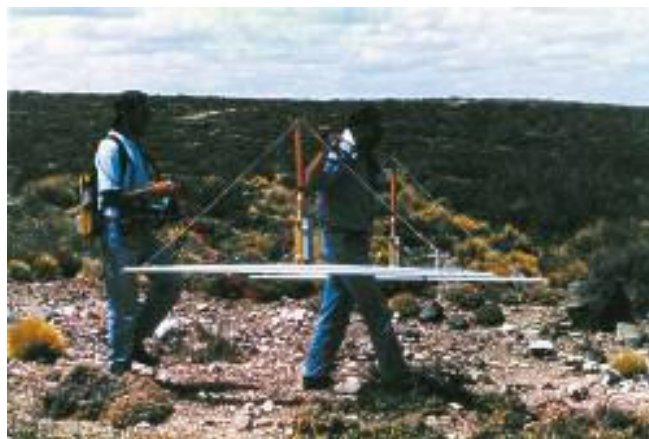
Figura III.XIX Equipo Georadar con antena biestática de 50 MHz para investigaciones geológicas profundas.
