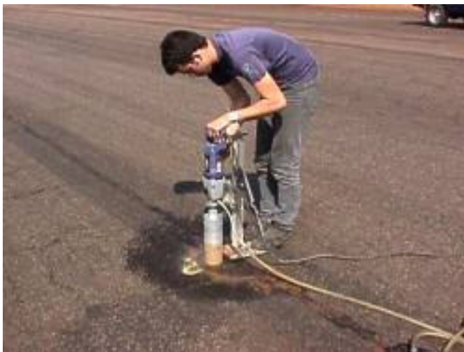
Pruebas en sitio para muestreo de tipo de subsuelo.
