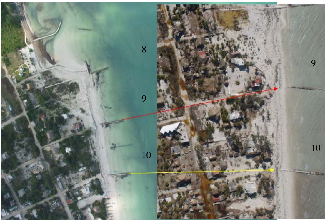
Figura 17. Erosión en los espigones 8 al 10.
