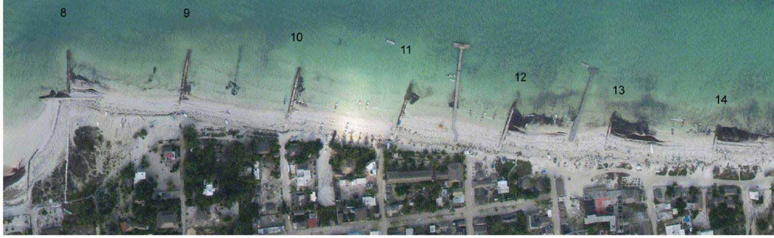
Figura 13. Donde se muestran todos los espigones y también se puede apreciar la franja de transporte horizontal de sedimentos, paralela a la playa al final de los espigones.
