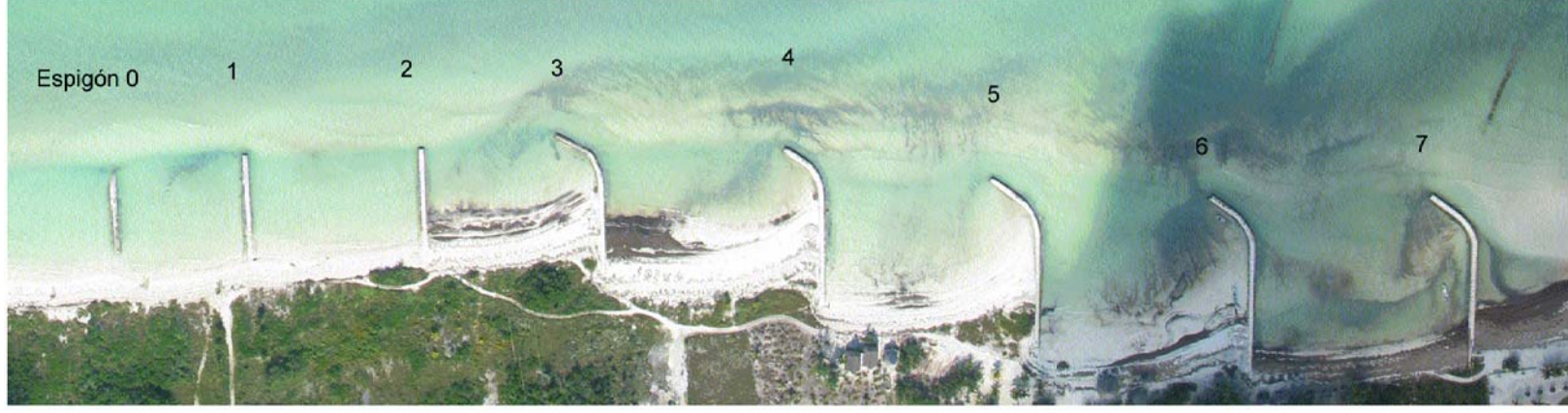
Figura 13. Donde se muestran todos los espigones y también se puede apreciar la franja de transporte horizontal de sedimentos, paralela a la playa al final de los espigones.
