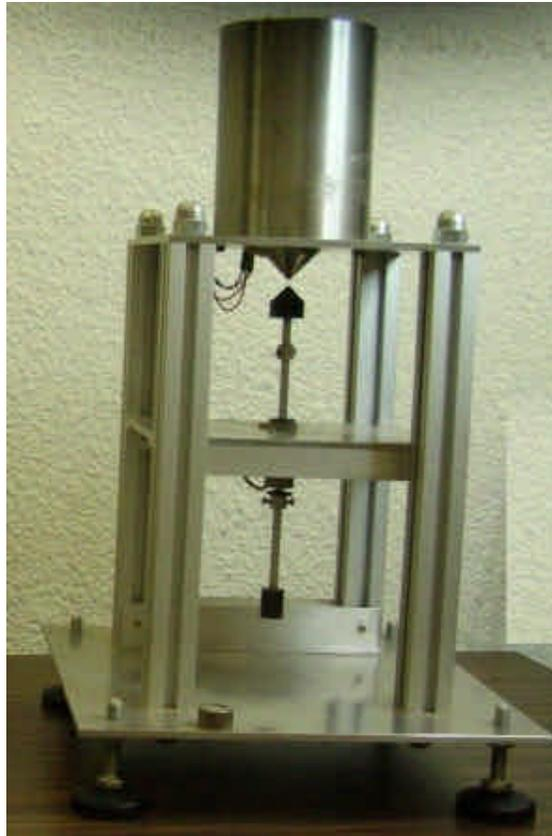
Figura 2.1 Sistema de Suspensión Magnética AMIRA MA400
