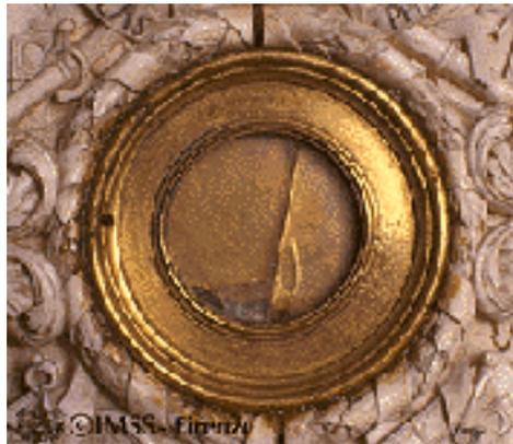
Visor del *cannocchiale* con el cual Galileo descubrió los satélites de Júpiter. Istituto e Museo di Storia della Scienza, Florencia, It. Inv. 2428. El visor original se ha perdido y se ha sustituido en el 800 por un visor biconcavo de 22 mm. de diámetro, espesor en el centro de 1.8 mm., distancia focal de -47.5 mm. (la distancia focal negativa indica que se trata de una lente divergente).
