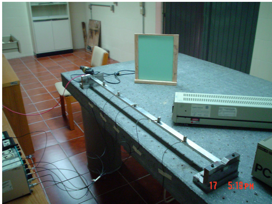
Modelo de la Viga doblemente empotrada.
