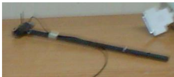
Transductor de Fuerza y Martillo para la excitación.
