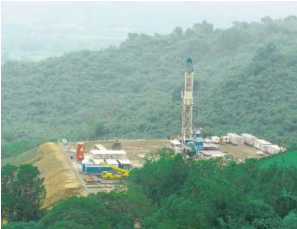
Fig. V.39. Equipo de perforación del Paleocanal de Chicontepec, construido para optimizar los tiempos y logística de perforación, en localizaciones de pozos múltiples.
