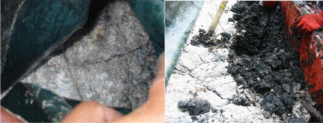
Figura 4.8 Vista de la nata de lodo formada en la superficie del digestor durante los últimos días, (día 214) de operación
