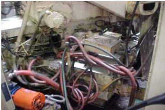
**Fig. 4.1** Mangueras en mal estado
