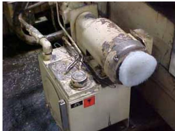
**Fig. 4.8** Motor de lubricación
