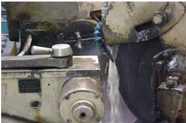
**Fig. 4.5** Piedra que rectifica la pieza
