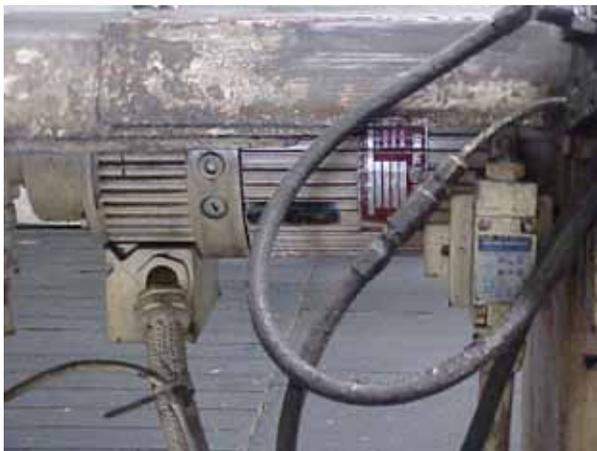
**Fig. 4.7** Servomotor del eje Z
