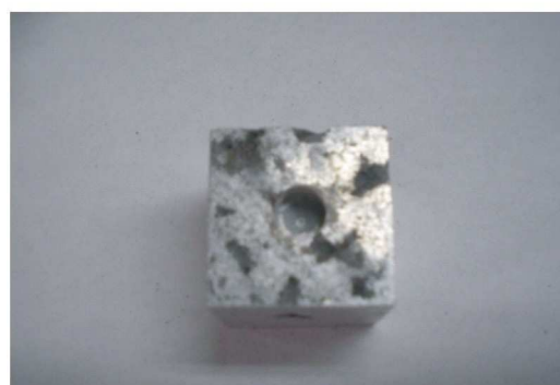
Figura 3.3.7: Estado físico de la aleación de Al- 5.5. % at Zn- 6.5 % at. Mg al final del ensayo NACE.
