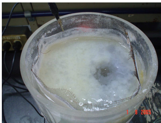
Figura 3.4.9: Celda de acrílico en la cual estuvo inmerso en ánodo durante todos los ensayos NACE.
