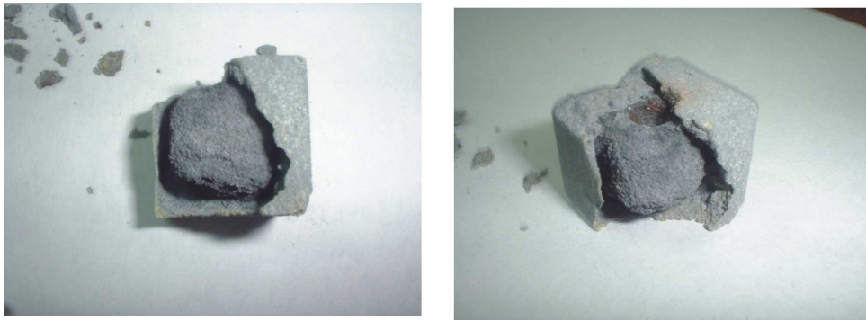
Figura 3.4.10: Estado físico de la aleación al final del ensayo NACE con el cuádruple ( 16 \text{ mA/cm}^2 ) de densidad de corriente aplicada.
