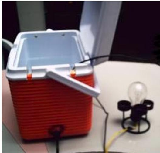
Figura 5.2 Prueba del Sensor con Foco de 200W.
