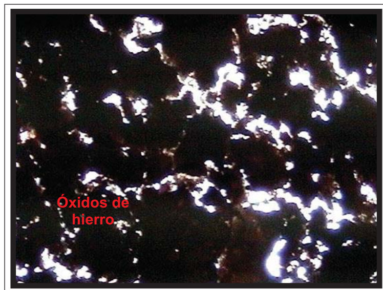
Fotomicrografía 20 de la muestra con clave MS09 (NII 2X) en donde se muestra la roca formada por fragmentos de óxidos de hierro cementados o sostenidos por cristales de calcita.
