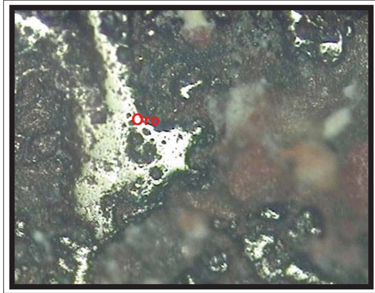
Fotomicrografía 5b de la muestra M2 de la Rampa 35 de la mina la Subida (NII, 10X), en donde se observa los cristales de oro en placas automórfica entre metidos en los cristales de aragonita.
