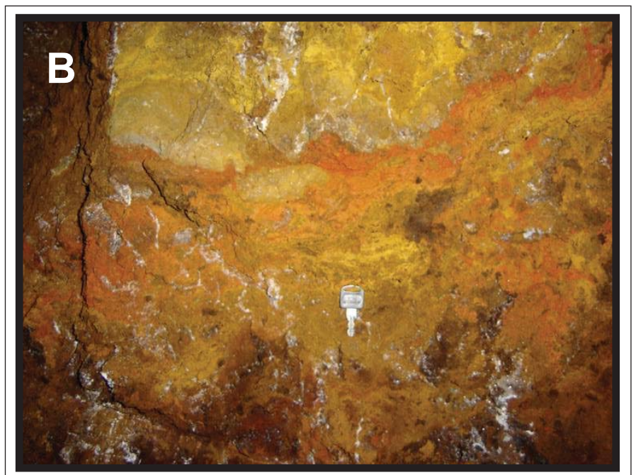
Fotografía 7. A y B. Óxidos de hierro masivo aurífero con cuarzo coloidal y calcita
