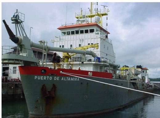
La draga Puerto de Altamira, es una draga autopropulsada de tolva equipada con un sistema de descarga a tierra .
