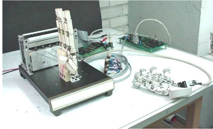
Ilustración 6 Manipulador Antropomórfico Teleoperado diseñado en la UNAM
