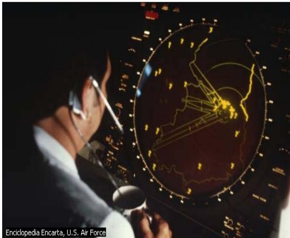
Las pantallas de radar muestran la presencia y el movimiento de objetos fuera del alcance de la vista, lo que resulta especialmente útil en la navegación. El equipo electrónico registra el comportamiento de las ondas de radio proyectadas por el barco. Las ondas que no chocan con ningún objeto se dispersan, mientras que las reflejadas denotan la forma y posición de los objetos
