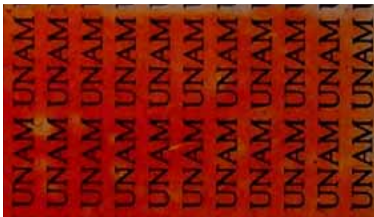
Figura 4.1: Fotografía de una película híbrida, sol-gel (40 %) con dopante RED-PEG-2 (60 %) sobre sustrato de vidrio. las dimensiones de la muestra son 5 cm x 2.5 cm, el fondo de la película es una hoja blanca bond con letras negras con la leyenda: UNAM
