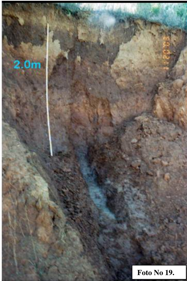
Foto No 19.- Afloramiento del flujo subterráneo de tipo local, entre las unidades C y D que corresponden al paleosuelo y cenizas, respectivamente. Este flujo con dirección perpendicular a la cara del talud, provoca un empuje hidrostático que sumado con el incremento de la presión de poro y del peso volumétrico, además de un comportamiento sumamente plástico del material provoca que las unidades B y C sean las más inestables y que al interior de ellas se formen superficies principales de deslizamiento.
