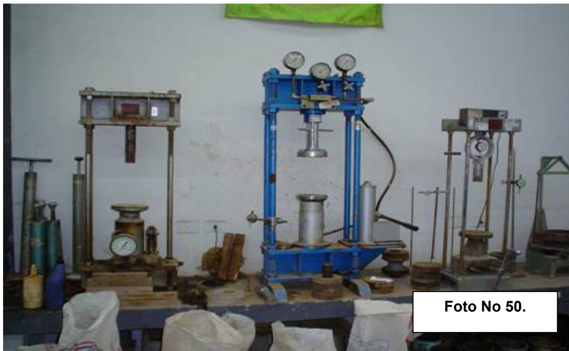
Foto No 50.- Fotografía que muestra los equipos para los ensayos de pruebas a terracerías, como son de izquierda a derecha, extractor de muestras con manómetro de presión, prensa Porter y prensa V.R.S. estándar o penetración. Así como todos los aditamentos como son pesas, manómetros, medidores de deformación, micrómetros, etc. (Fuente: Propia).
