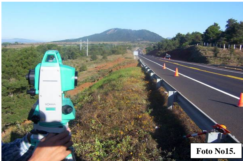
Foto No 15.- La fotografía muestra la semi-estación de la línea Sokkia Set-510 que se utilizó para la realización del levantamiento topográfico.
