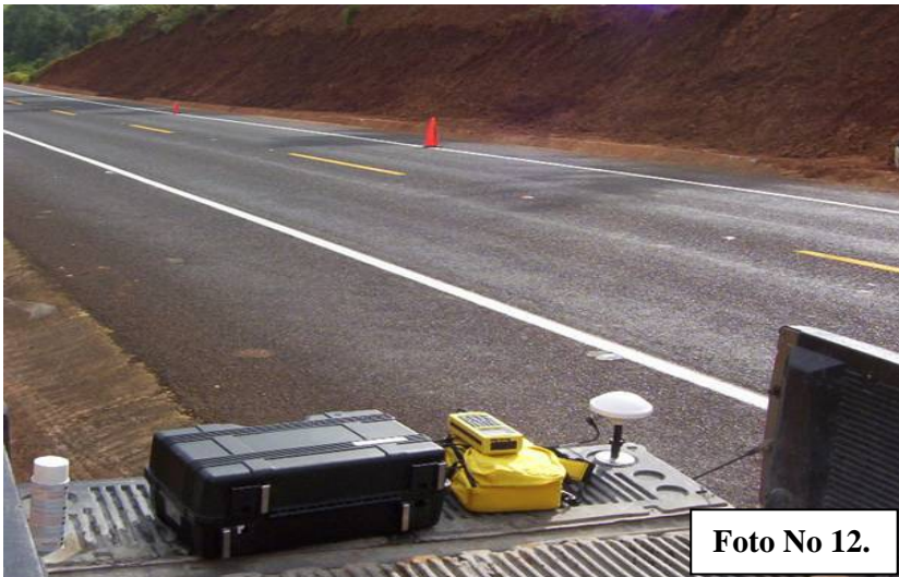
Foto No 12.- En ella se observa el aparato navegador de GPS (Sistema de Posicionamiento Global), de la línea Sokkia Receptor Stratus el cual se utilizó para la obtención de las coordenadas de referencia, las cuales fueron en unidades de UTM.
