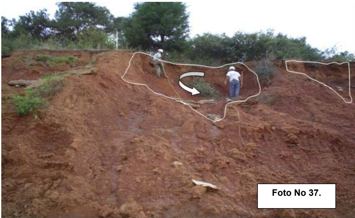
Foto No 37.- Muestreo de los taludes del tramo Km. 62+530 al Km. 62+640, se trabajaron de 3 a 4 muestras inalteradas por columna de talud, es decir, una por cada estrato diferente de suelo. Observe las zonas donde por el exceso de humedad se provoca una falla local en el talud, en este caso en la parte superior ha fallado por rotación y se ha llevado consigo la contracuneta de concreto (Fuente: Propia).
