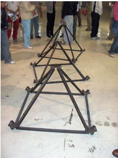
34. Pirámides de experimentación, compuestas de acero, aluminio y fibra de carbono.
