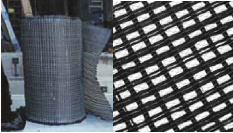
34. Forma de presentación de las láminas (MapeWrap C); en la imagen de lado derecho se aprecia en detalle el bidireccionado de la fibra.
