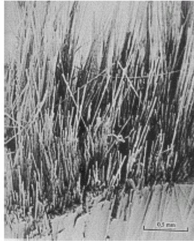
18. Ejemplo de fractura de fibra de vidrio bajo carga axial.
