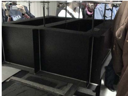
18. Viga compuesta en su totalidad por laminas de fibra de carbono, cuya función era la de experimentar su resistencia y ligereza, realizada en Grupo Adriann's de México, México.
