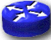
Funciona en la capa de red, se encarga del enrutamiento de paquetes entre redes interconectadas. A través de tablas y algoritmos de enrutamiento, decide el mejor camino que debe tomar un paquete para llegar a una determinada dirección de destino. Permite la conexión de una red LAN hacia una red WAN. Desde el punto de vista del hardware es siempre el mismo, modificándose el software incorporado. Las interfaces de salida dependen de la velocidad a ser utilizada:
