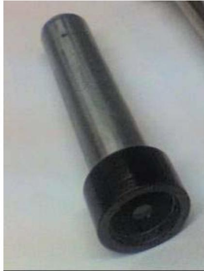
Figura 2.20. Tubo de 2.2cm de diámetro con montura y lente
