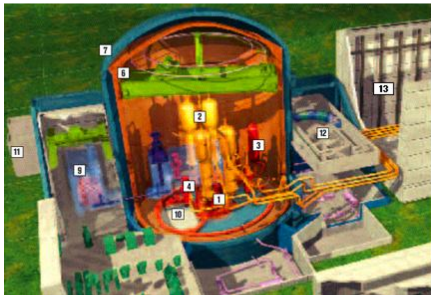
Figura 2.13 Principales componentes de la planta nuclear EPR [11]
