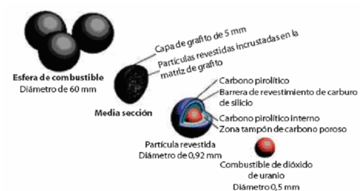
Figura 2.22 Composición de la esfera de combustible de un PBMR [23]
