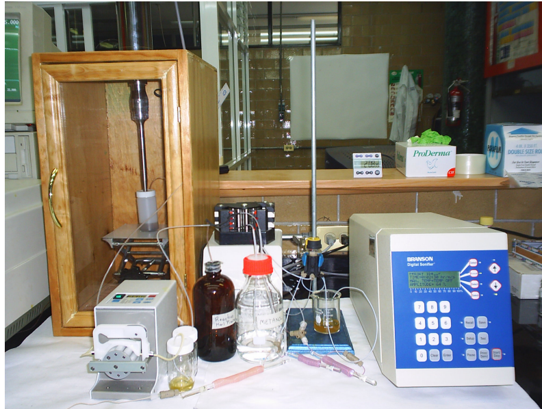
Figura 2.4 Configuración FIA acoplada a la extracción asistida con ultrasonido focalizado
