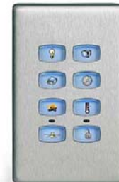
Foto 48. Control de iluminación y aire acondicionado
