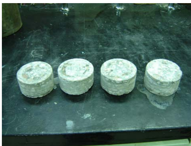
Cilindros utilizados en la prueba de permeabilidad a los cloruros.
