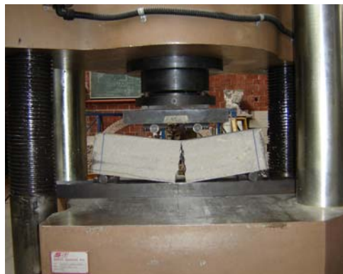
Prueba de tensión por flexión
