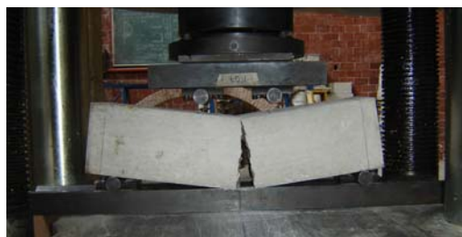
Prueba de tensión por flexión
