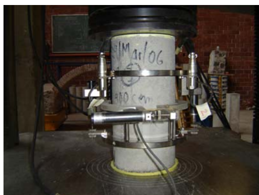
Equipo para prueba de módulo de elasticidad y Relación de Poisson
