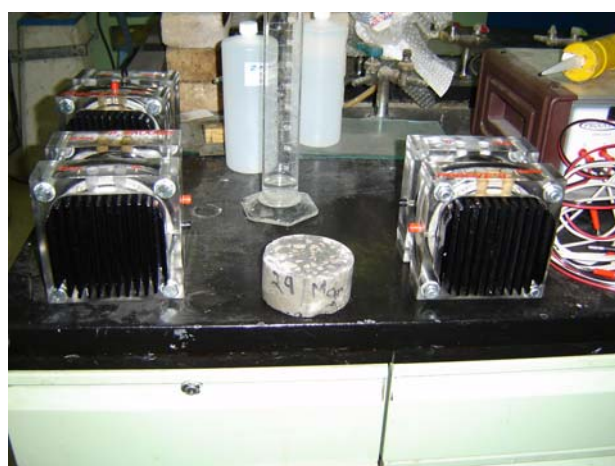
Prueba de permeabilidad a los cloruros
