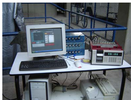
Equipo para prueba de módulo de elasticidad y Relación de Poisson
