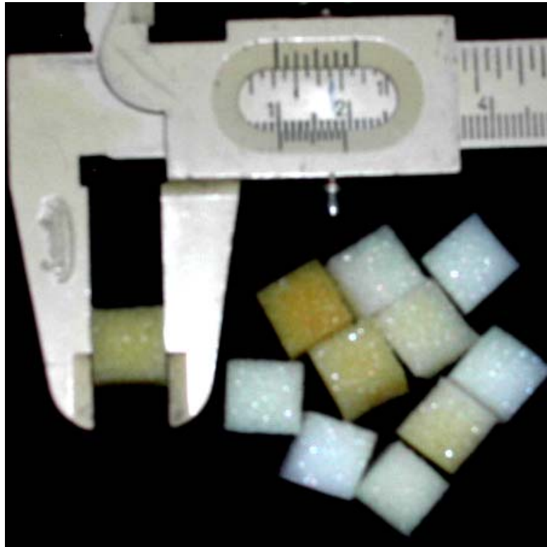
Figura 3.3 Cubos de poliuretano (material de soporte) sin película biológica.
