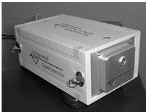
Figura 4.3: Fotografía del espectrómetro PIMA II (tomado de http://www.pimausa.com/ ).
