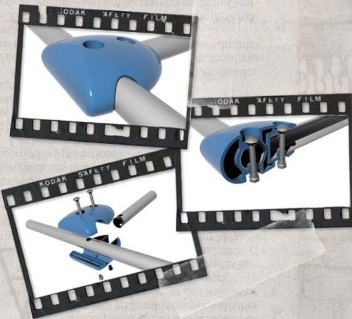
**Conector pequeño (Cp)** El conector pequeño se encuentra conformado de dos piezas de fundición de aluminio huecas (4mm de pared), que abrazan a dos tubos en forma perpendicular, su función es la de unir dos piezas de formas distintas en diferentes direcciones. También se puede ocupar para escalar.
