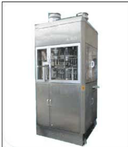
Máquina rotativa para elaborar tabletas de una capa o de doble capa.
