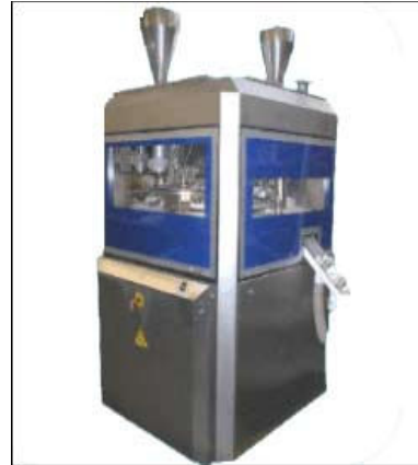
Máquina rotativa para elaborar comprimidos de doble capa.
