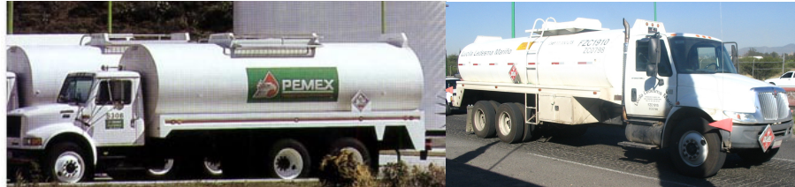
4a) Vehículos autotanque del tipo C3 con contenedor de 20 mil litros.
